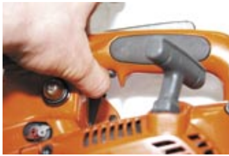
Der Haken hinter dem Gashebel der Husqvarna 334 T stört etwas beim Dosieren.
