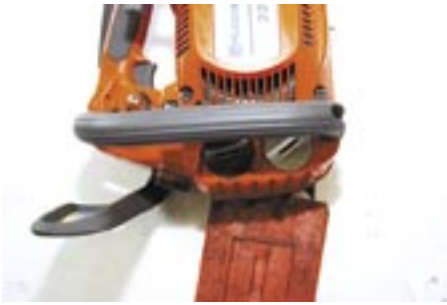
Die Tankklappen der Husqvarna 334 T wurden verbessert: Schlitzverschluss für Motorsägenschlüssel geeignet. | Fotos: Johswich.
