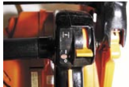
Ungewohnte Anordnung des Start-Stopp-Schalters bei der Echo 350 TES: Die Bedienung erfolgt umgekehrt wie bisher von anderen Sägen gewohnt. | Foto: Johswich.
