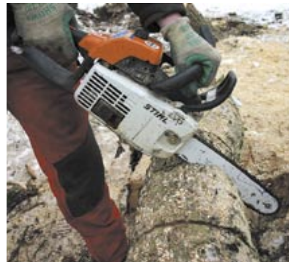
Unterschiedliche Hebelkräfte aufgrund verschiedener Griffanordnungen bei der Top-Handle-Säge (links) und der kompakten Profisäge (oben). | Fotos: Andresen.
