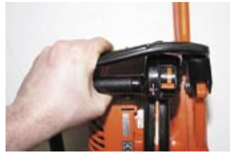
Der Handschutz der Kettenbremse bei der Echo 350 TES verbiegt sich beim Lösen sehr und das Einrasten ist nur mit einem harten Schlag möglich.
