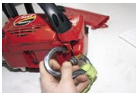
Die Konzeption der Anschlagöse bei der kleinen Echo (baugleich mit Shindaiwa) ist für das Klettern problematisch: Sehr mühsames Einfädeln von Karabinern. Nur ein kleiner Karabiner passt. | Foto: Johswich.
