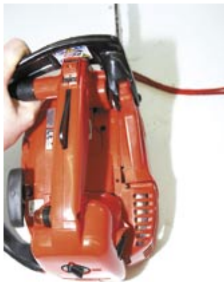
Der Handschutz der Kettenbremse ist bei der Echo CS 2500 und der Shindaiwa 269 T eine Fehlkonstruktion. Beim Lösen verbiegt sich hierbei sogar das Seitenteil! Foto: Johswich.
