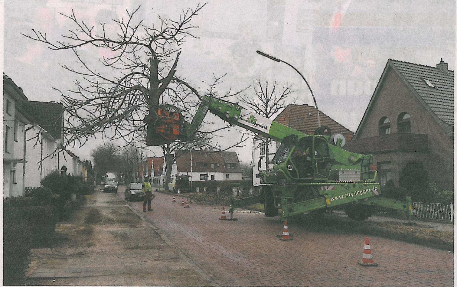
Da kippt nix: Die an einem Greifarm befestigte Spezialmaschine schneidet ein Baum-Segment nach dem anderen ab und befördert es anschließend zu Boden. Der sogenannte Fällkran der Bremer Fachfirma war gestern an der Gartenstraße im Einsatz.
